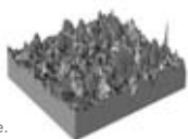
Image agrandie d'un verre de douche ordinaire, présentant des traces de corrosion suite à une utilisation quotidienne.
